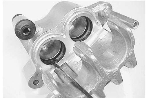
**CALIPER INSPECTION****BRAKE CALIPER**
